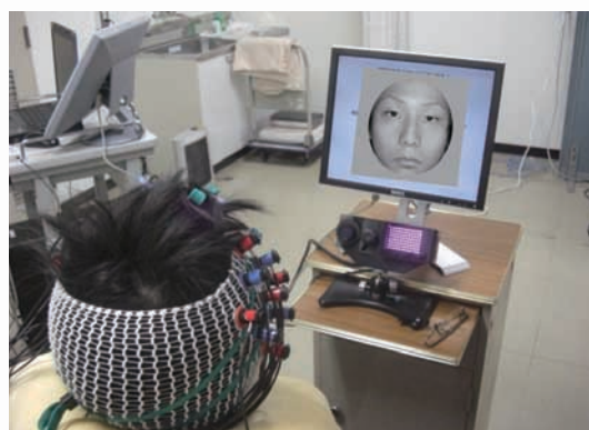
視線観察と脳血流を同時に計測する 顔認知研究システム
