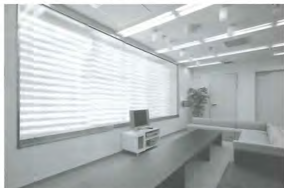
睡眠実験室リビング 非常に明るい照明を行う装置が設置されていて5000ルクスから10000ルクスの照度にする事ができます。体内時計の調節に使います
