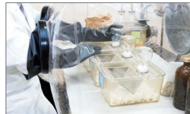
無菌マウスを用いた実験を行う装置、無菌アイソレーター。装置内では細菌が全く存在しない環境や、特定の細菌だけが存在する環境での実験を行うことができる。
