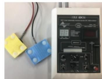
図1: 経頭蓋直流刺激装置
