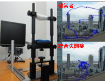
眼球運動検査のセットアップ(左)と、モニタ上に表示される写真を見ている時の視線の動き(青線、右上: 健常被験者、右下: 統合失調症患者)
